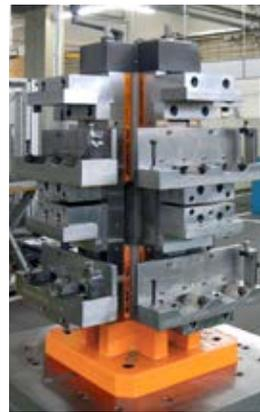
Monoblock DUO 125 4 x 90° in Sonderausführung zur Bearbeitung komplexer Gussteile
