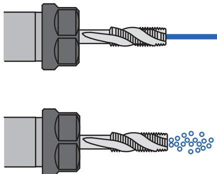
Hochdruck-Innenkühlung durch die Spindel
