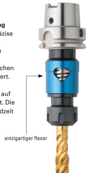
Durch Limitierung des axialen Kompensationsweges und auf den Flexor wirkende Drehkräfte, können Millionen von Gewinden produziert werden, ohne dass das SynchroFlex® Futter ermüdet, seine Form verliert oder Verschleiss auftritt. Nachfolgend ein Beispiel einer Stressanalyse bei maximaler Kompression.
