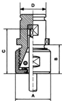
Der Werkzeugspannbereich ist mit nur 2 Mehrbereichsspannzangen abgedeckt.
