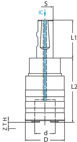
Längenausgleichfutter mit innerer Kühlmittelzuführung. Mit dieser Schnellwechselfutter können die Gewindebohrer in Sekundenschnelle gewechselt werden.
